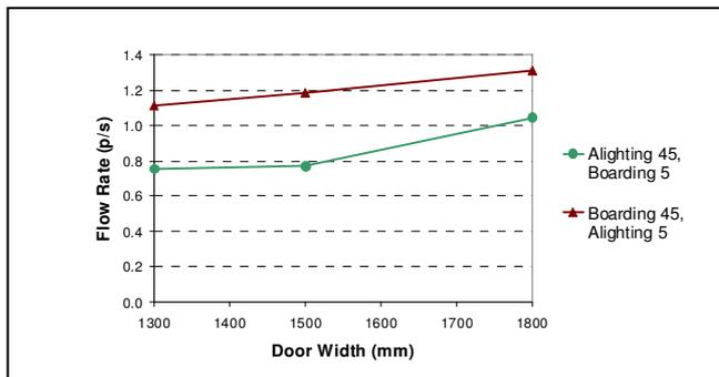
Fig. 1 Effect of door width
